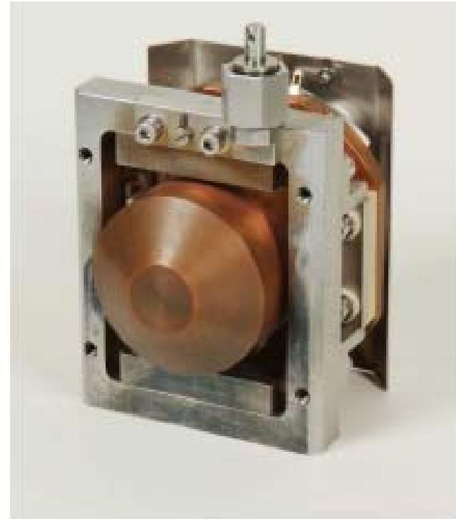
Cage de Faraday non refroidie (Linac de GSI) Diamètre utile: 50 mm avec dispositif magnétique et électrique de suppression d'électrons secondaires
