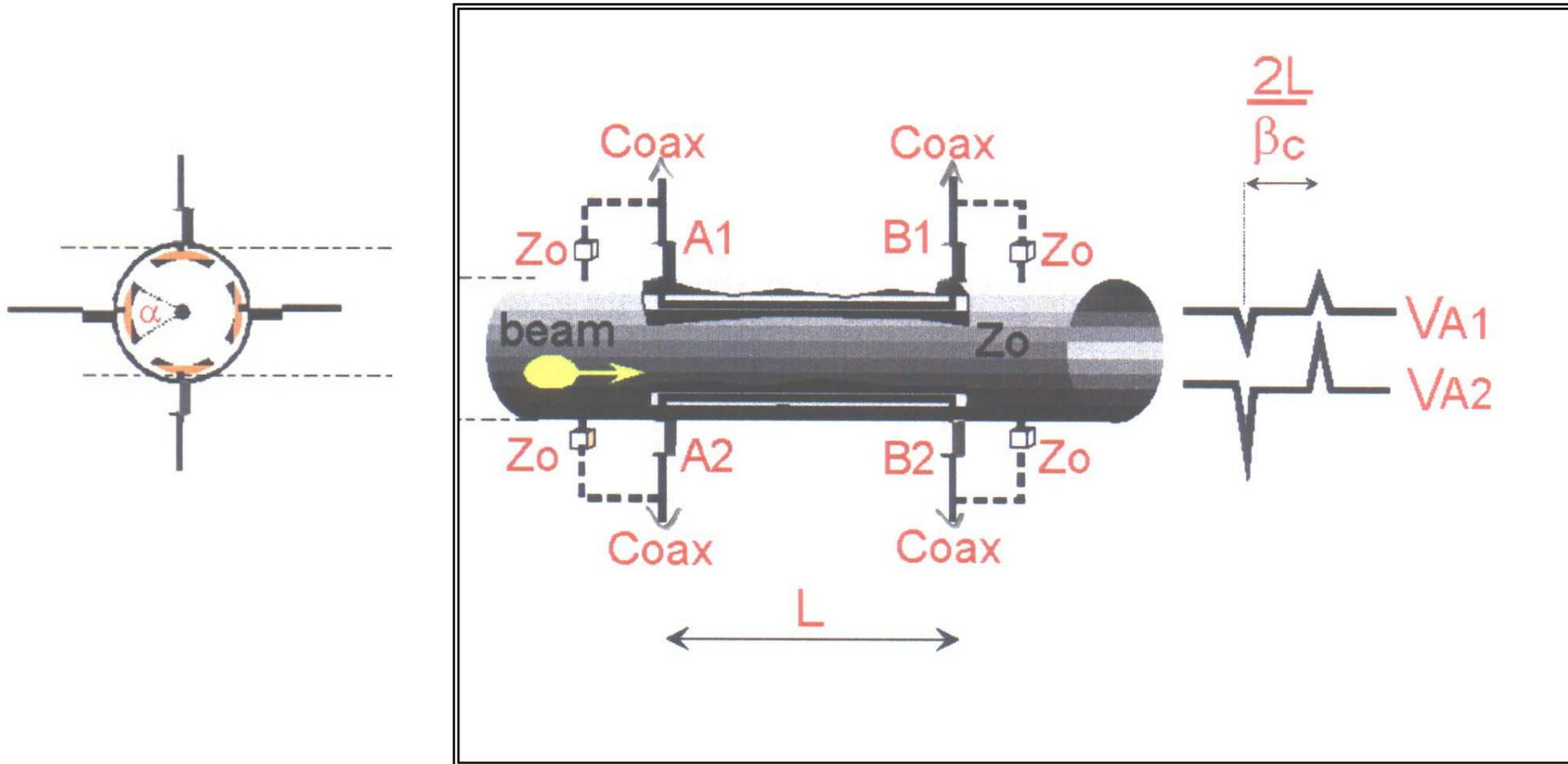
Schéma de principe d'un coupleur directionnel ou « stripline »
