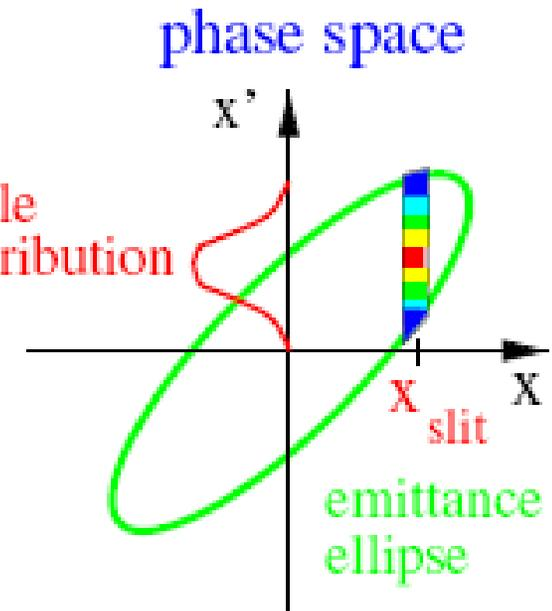
Résolution en  $x$  : Ouverture la fente (typique 0.1 à 0.5 mm)
