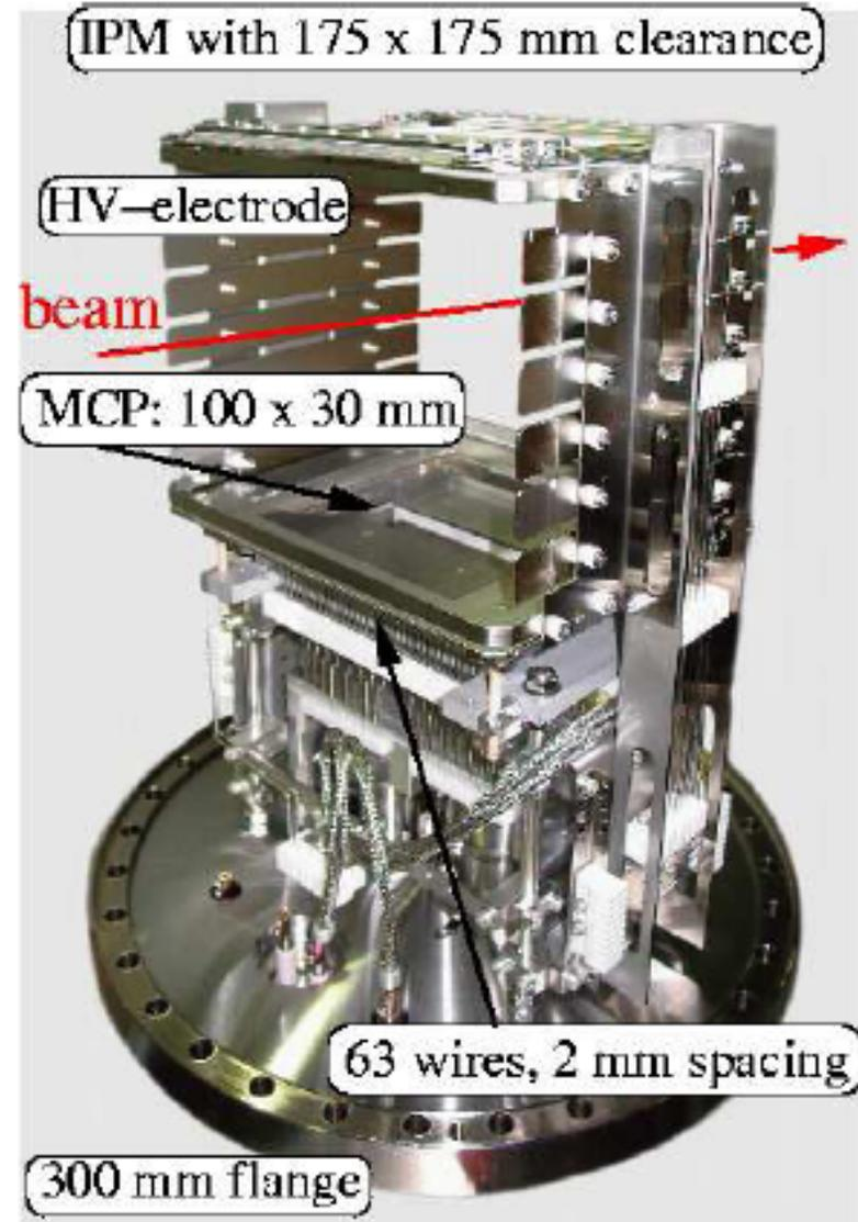
Sonde à ionisation du gaz résiduel sur Synchrotron GSI
