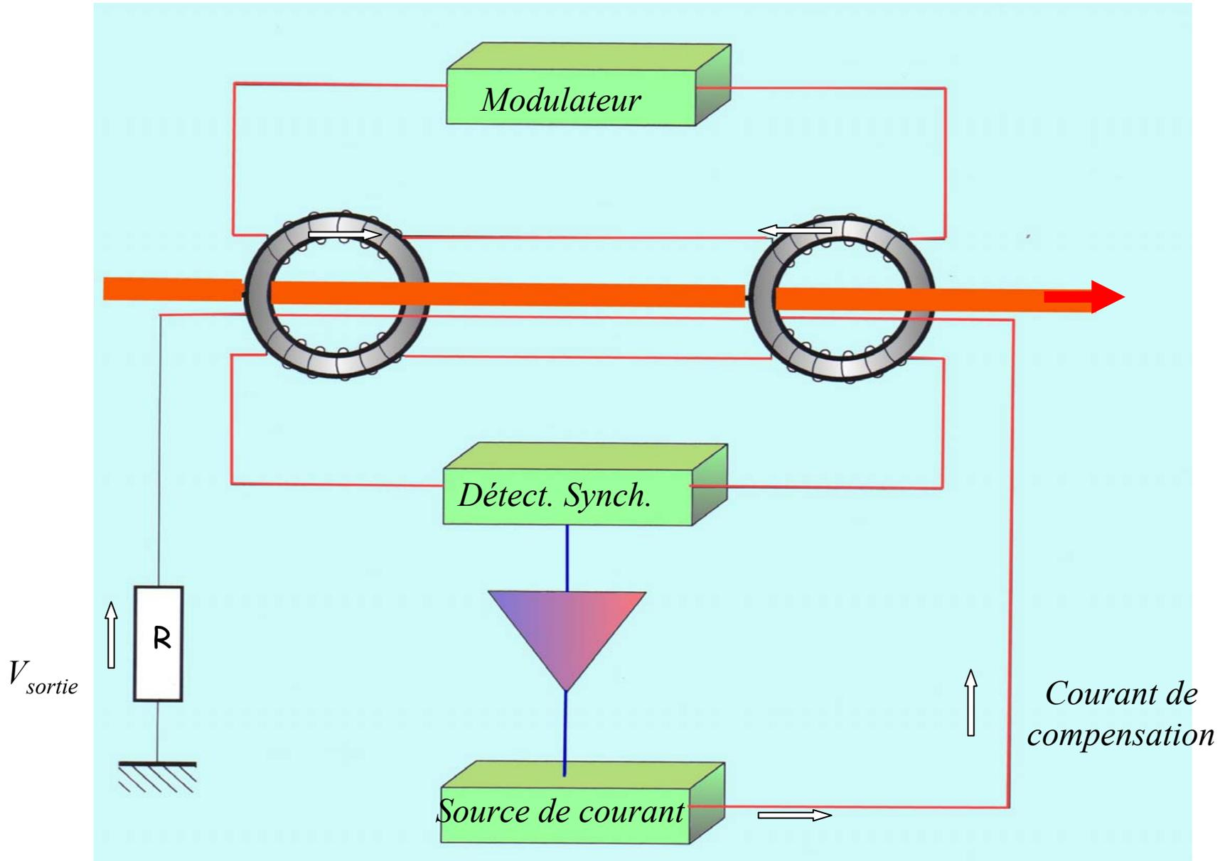
*Principe de fonctionnement du transformateur d'intensité « D.C.C.T ».*
