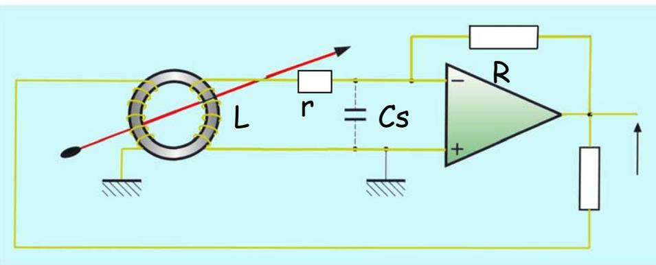
*Transformateur AC actif à contre-réaction
