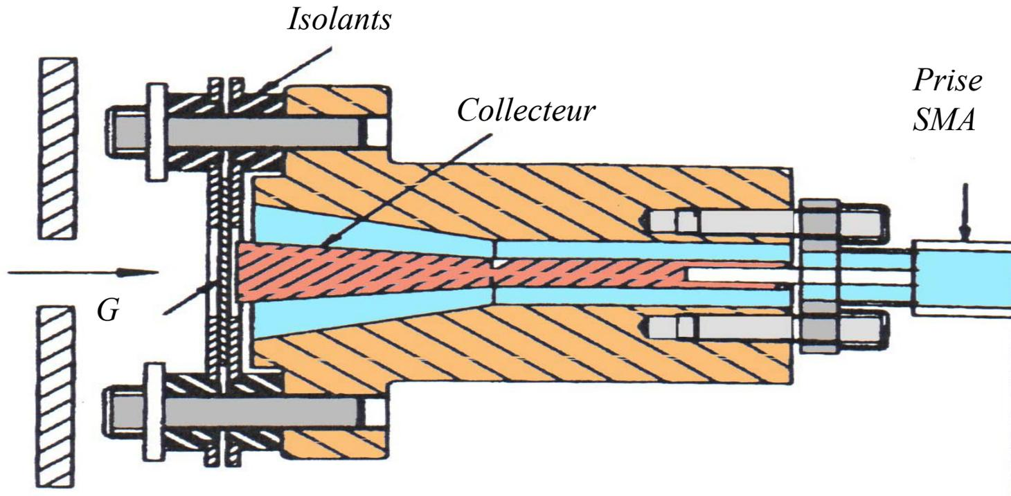
Schéma de principe d'une cage de Faraday adaptées aux hautes fréquences
