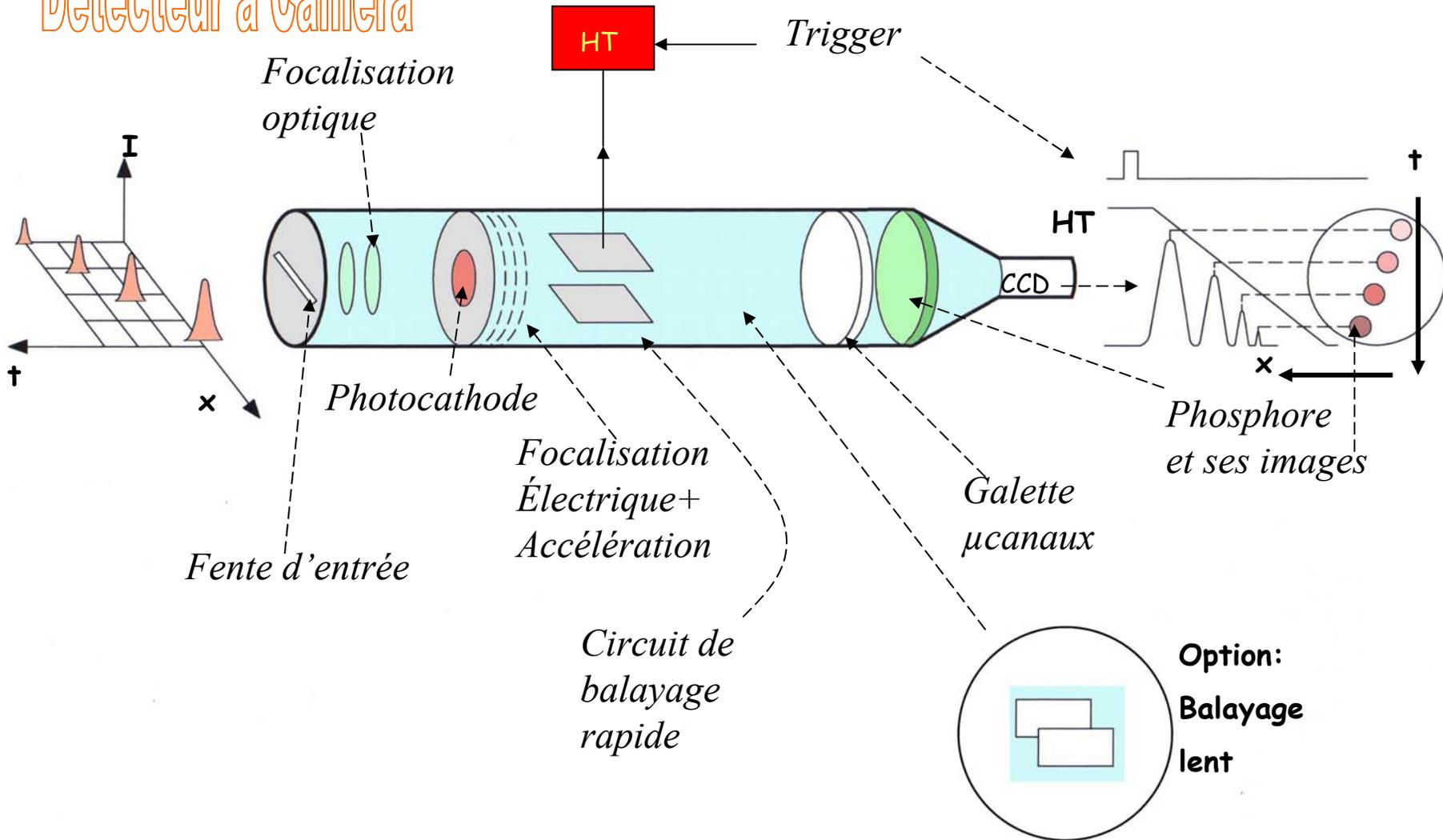
Principe d'une Caméra à Balayage de Fente
