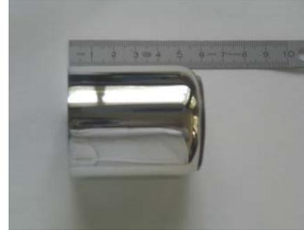
Détecteur : 50 mm de long et diametre 50 mm
