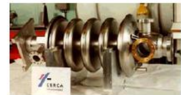
Cavité APT (Los Alamos) 700 MHz - \beta = 0,64
