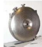
Cavité ré-entrante (Legnaro) 352 MHz - \beta \geq 0,1
