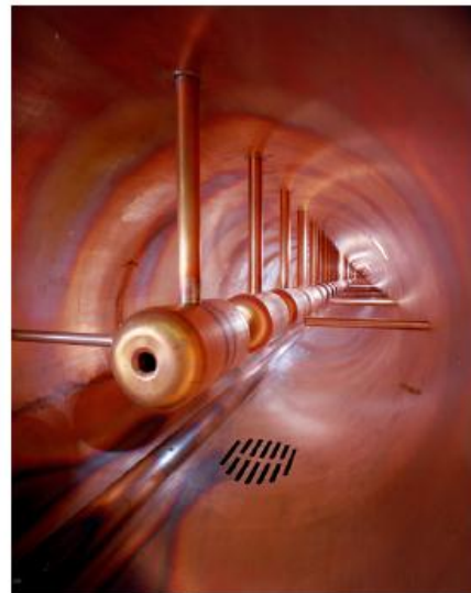
Fermilab DTL : -> 116 MeV, 425 MHz
