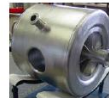
Cavités spoke (CNRS Orsay) 352 MHz - \beta = 0,15 et 0,35
