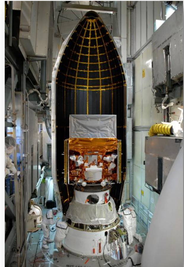
Installation de GLAST/FERMI dans la fusée DELTA II
