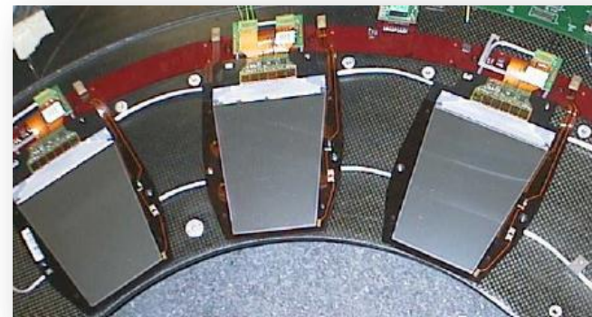
Détecteur semi conducteur (Tracker CMS)
