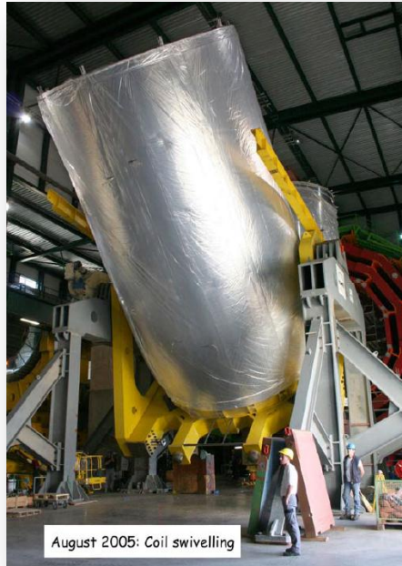
Outil de support et de rotation de la bobine de CMS
