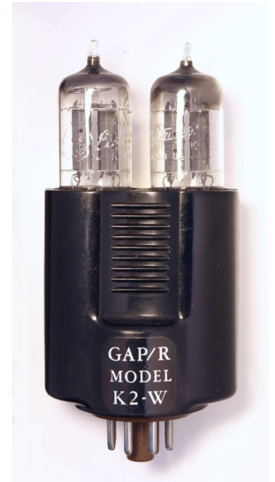
AOP à tubes K2-W (1953)
