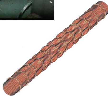
FLAMBAGE MODE 7 COEFFICIENT 3.33 FLAMBAGE ELASTIQUE CART 2
