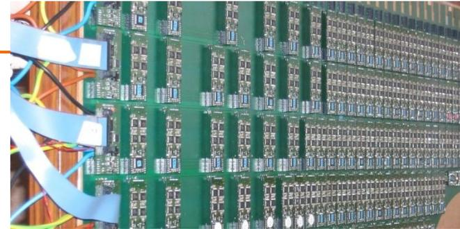
Etude et construction de l'électronique pour l'ensemble des chambres à fils
