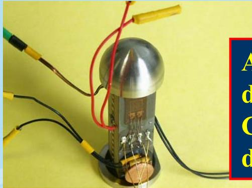
Actionneur PICMA muni d'une chaufferette, d'une CERNOX étalonnée et d'une jauge de contrainte
