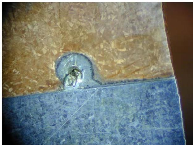
Le procédé sous four sous vide permet de brasier plusieurs joints d'un même ensemble cependant l'écoulement du métal fusible peut réserver quelques difficultés. Des essais pour déterminer le temps et la température de brasage ainsi que le montage et la position des différentes pièces sont généralement nécessaires.
