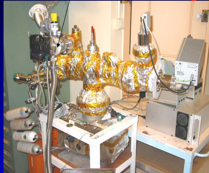
Étuvage d'un banc d'essai au LAL
