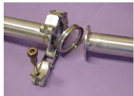
Il faut noter que les raccords de bride et collier sur des joints métalliques et « élastiques » sont difficiles à réaliser, qu'ils demandent un bon parallélisme des faces en jonction (un lubrifiant sec du type bisulfure de molybdène peut être appliqué sur les colliers mais attention à la pollution possible des chambres à vide).
