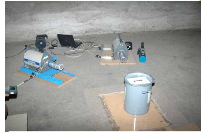
Identification d'un fût de déchets
