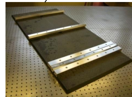
Plaque épaisse Carbone HR Ep. 13 mm , avec inserts et rails
