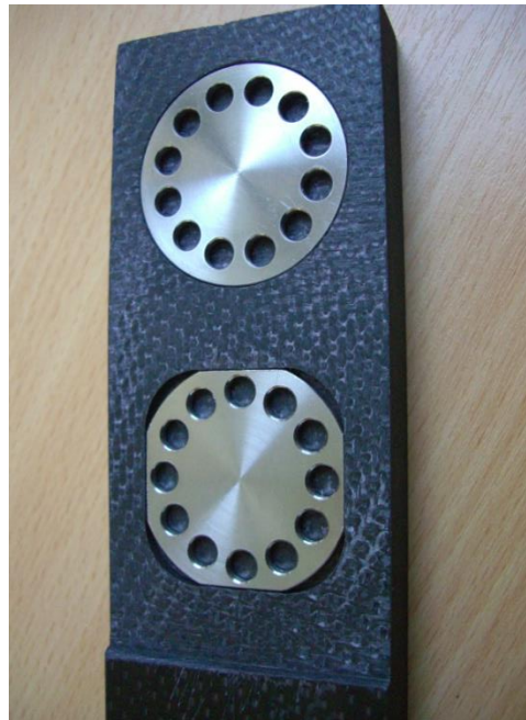
Plaque de fond et éprouvettes en fabrication (inserts collés avant drapage final – plaques finies)
