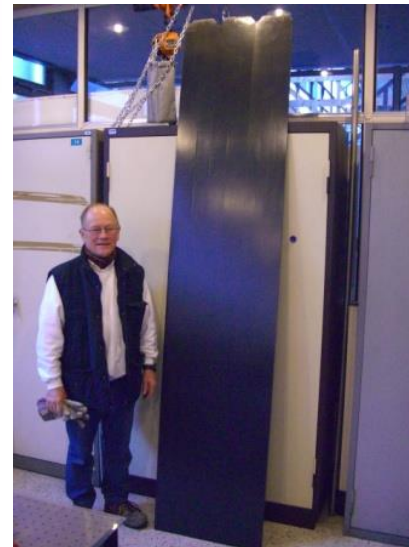
Moulage d'un layer 3 alvéoles L = 2.490 m Ep.paroi = 0.5mm
