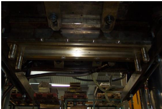
Poinçon monté sur la traverse de la presse
