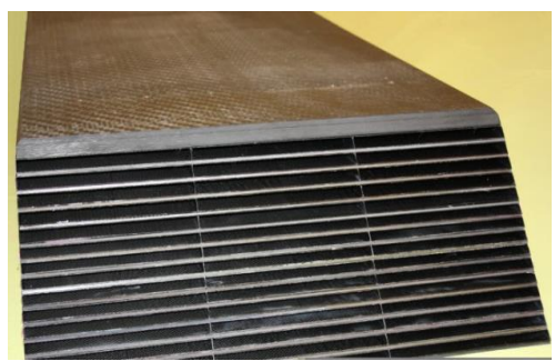
Des inserts métalliques sont noyés dans la plaque permettant la fixation des rails de guidage
