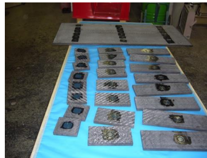
Plaque de fond et éprouvettes en fabrication (inserts collés avant drapage final – plaques finies)
