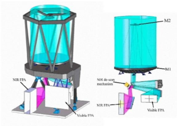
Telescope (1.2m) + imagerie visible+IR ( $\sim 0.5\text{deg}^2$  chaque)
