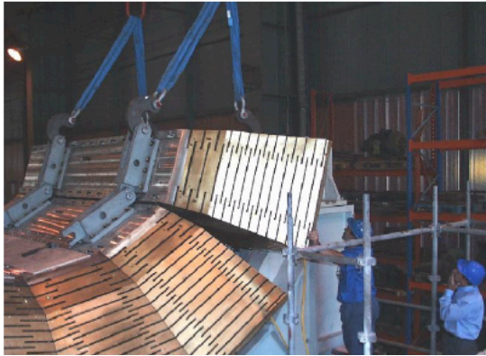
Absorbeurs en cuivre (1500 t) + scintillateurs
