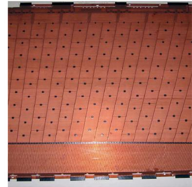
*Electrode Barrel après pliage*
