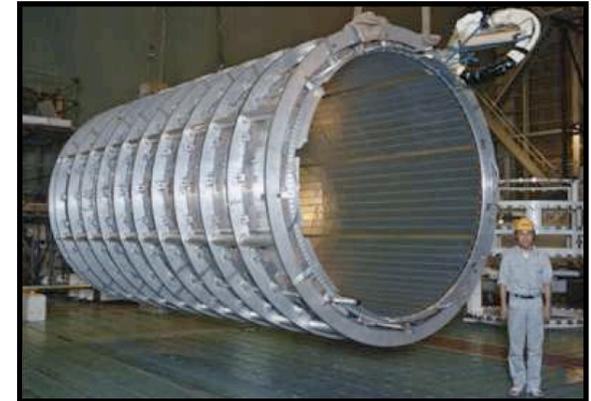
Toroïde End-Cap (2 x 8 bobines séparées dans un même cryostat)
