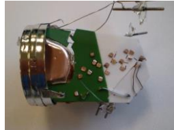
Rupture au pied du PMt
