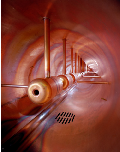
Fermilab DTL : -> 116 MeV, 425 MHz
