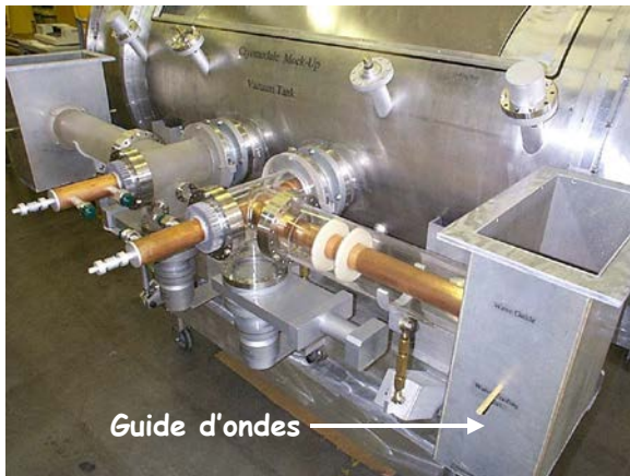
Connexion du cryomodule aux guides d'onde HF (maquette APT, Los Alamos)
