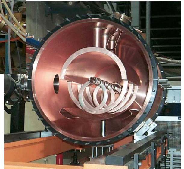
Résonateur 7-gap (Rex-Isolde), 101.3 MHz
