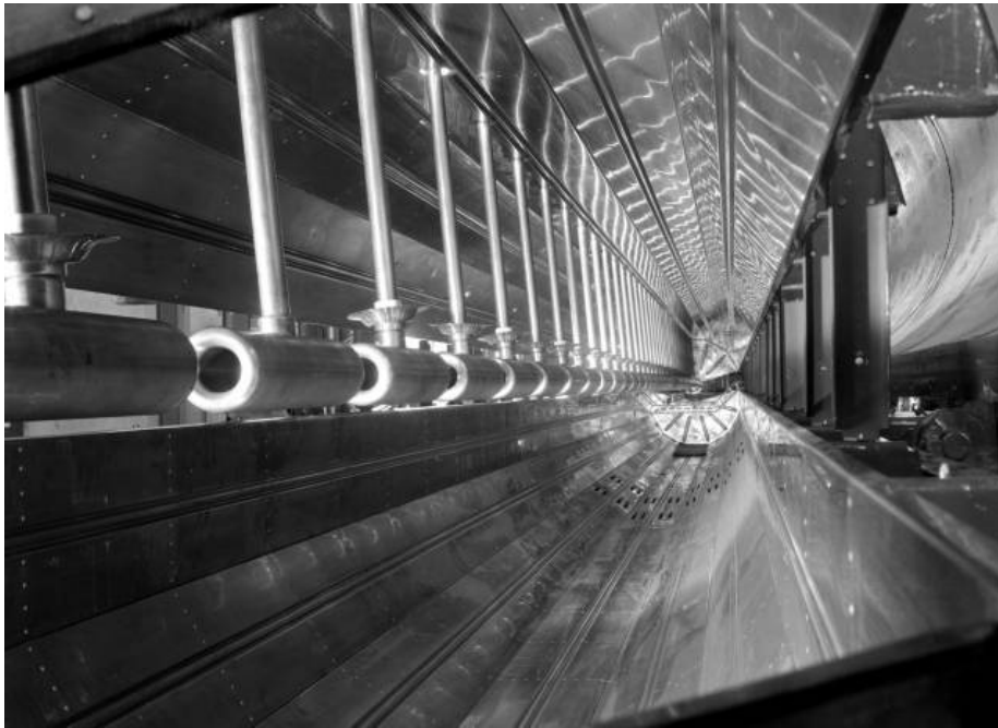
Le DTL d’Alvarez (Berkeley, 1946) : 200 MHz, p 4->32 MeV, 12 m
