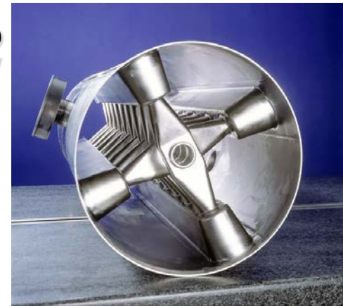
19-gap CH-DTL (Frankfurt)) 350 MHz - \beta \sim 0,1
