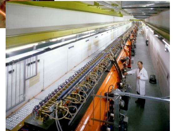
DTL Linac 2, (CERN, 1978) : 202 MHz, p 50 MeV
