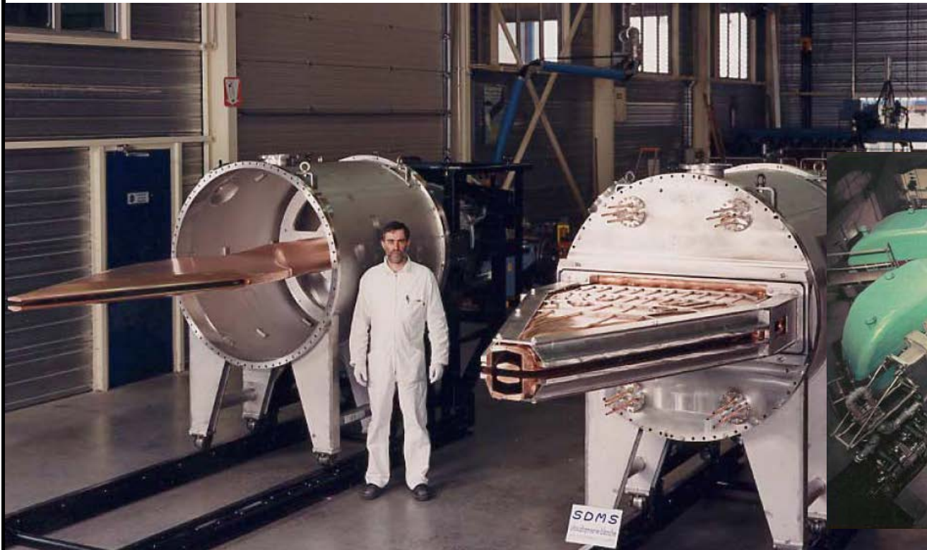
Cavités du cyclotron CIME (GANIL, 9.6 – 14.5 MHz, V_{\max}=100\text{kV} )
