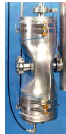
Résonateur demi-onde (Argonne) 355 MHz - \beta = 0,12
