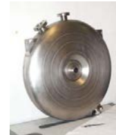
Cavité ré-entrante (Legnaro) 352 MHz - \beta \geq 0,1
