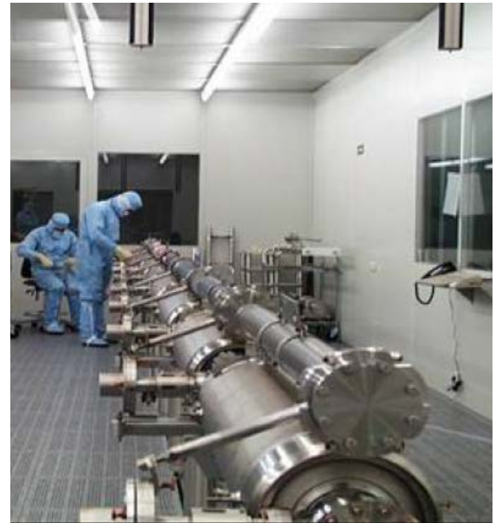
Assemblage d'un train de cavités TTF en salle blanche (DESY)
