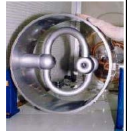
Résonateur à « hélice effilée » 81 MHz - \beta=0,09 (KFK → Saclay)
