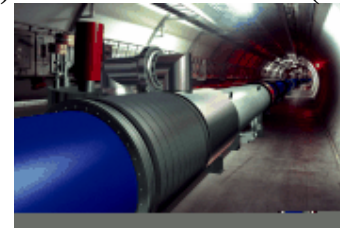
LHC (2007) 20 kW à 1,8K - 70 kW à 4,5 K
