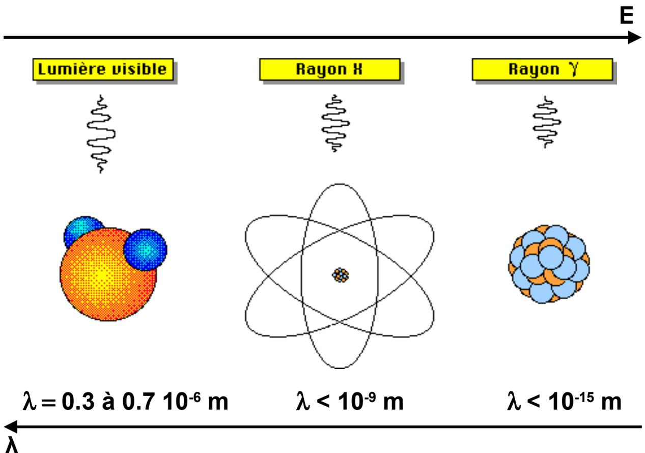
**Avec des photons d'énergie donnée on ne peut pas sonder des détails plus petits que  $\lambda$**
