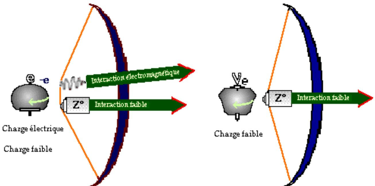
**Pour interagir avec la matière, l'électron dispose de charges électrique et «faible» et le neutrino d'une charge «faible»**
